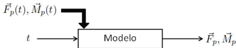
Figura 3.14 - Modelo do sistema propulsivo com força e momento conhecidos em função do tempo
