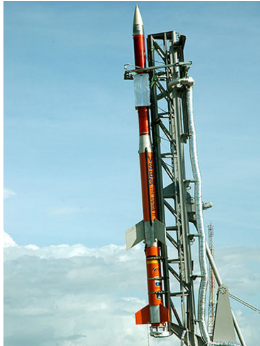
Figura 5.1 - Veículo VSB-30 no trilho de lançamento Fonte: (AEB, 2009)
