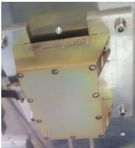
Figura 3.9 - Fotografia do sensor GPS da Vectronic Aerospace.
