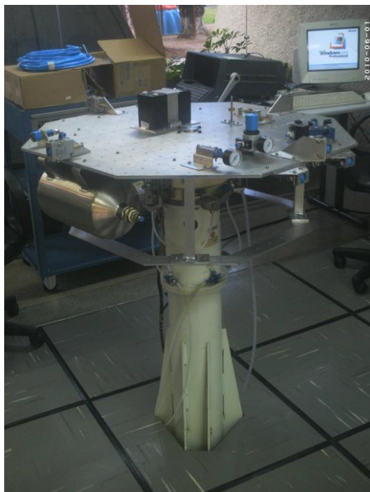
Figura 3.1 - Fotografia do mancamal semi-esférico do LABSIM/INPE.
