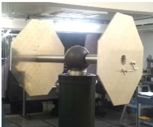
Figura 3.5 - Fotografia do mancal esférico do LABSIM/INPE.
