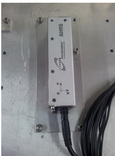
Figura 3.2 - Fotografia da unidade inercial AHRS da Innalabs fixada ao mancal semi-esférico.
