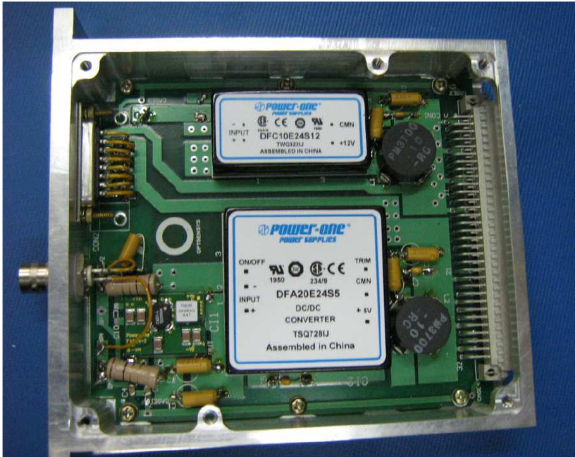
Figura B.7 - Módulo de fonte de tensão FT207 com vista dos componentes.
