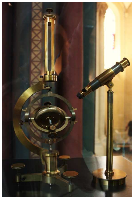
Figura 1.1 - Giroscópio de Léon Foucault, construído por Dumoulin-Froment em 1852. Fonte: Magnenat (2013)
