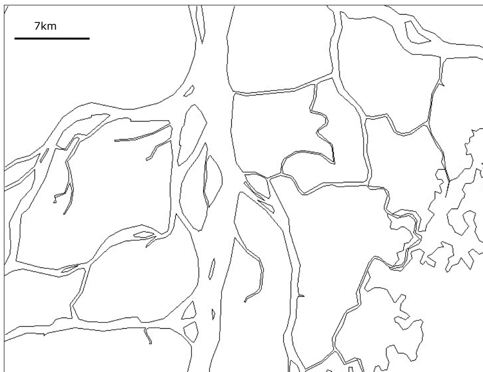
Figura 5.34 – Resultado adequado na mudança de 1:250.000 para 1:1.000.000.
