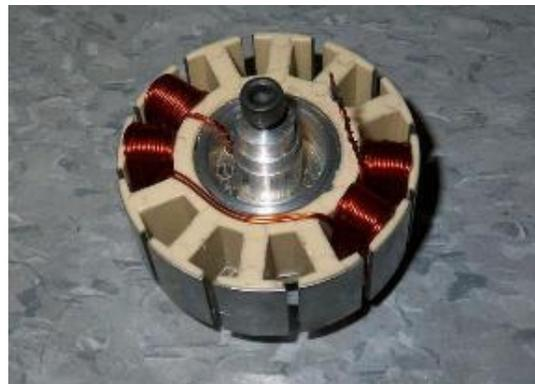
Figura 2.4 - Estator de um motor DC sem escovas.
