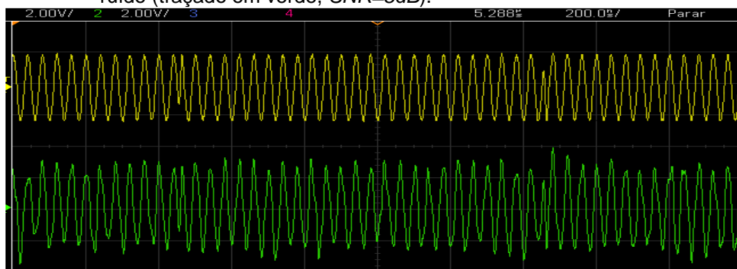
Figura 17 – Sinal BPSK no domínio do tempo sem ruído (traçado em amarelo) e com ruído (traçado em verde, SNR=8dB ).
