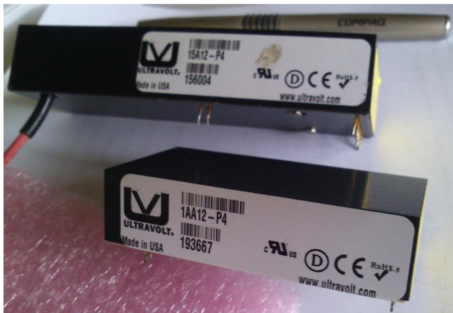
Figura 4.14 - Fontes Ultravolt originais do DD-PPT de 15 kV (superior) e 1 kV (inferior)
