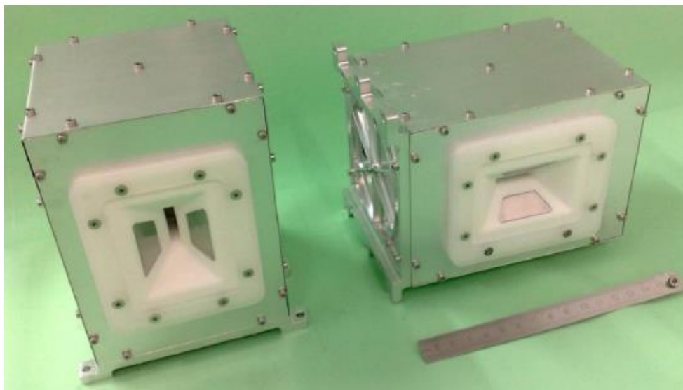
Figura 3.5 - Imagem do DD-PPT (no seu chassi) utilizado neste trabalho. Fonte: Fotografia que correspondente ao original (15)
