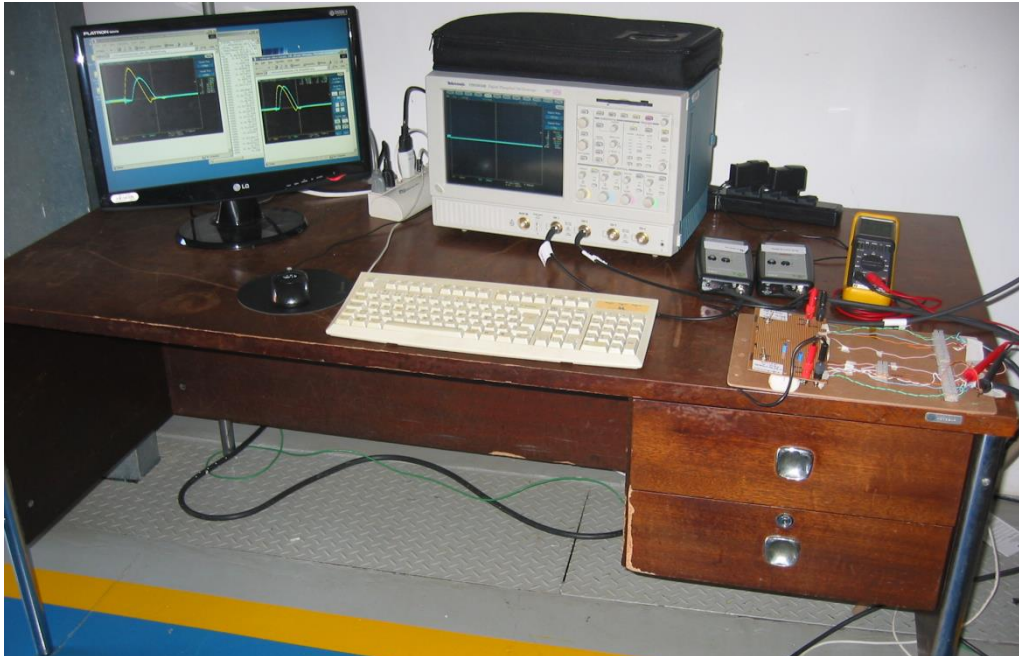
Figura 4.25 - Mesa de controle com os equipamentos para controle e aquisição de dados do propulsor
