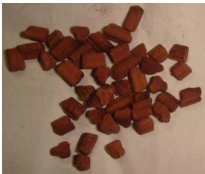
Figura 3.2 - Catalisador de óxido de ródio suportado em alumina ( \text{Rh}_2\text{O}_3/\text{Al}_2\text{O}_3 ).
