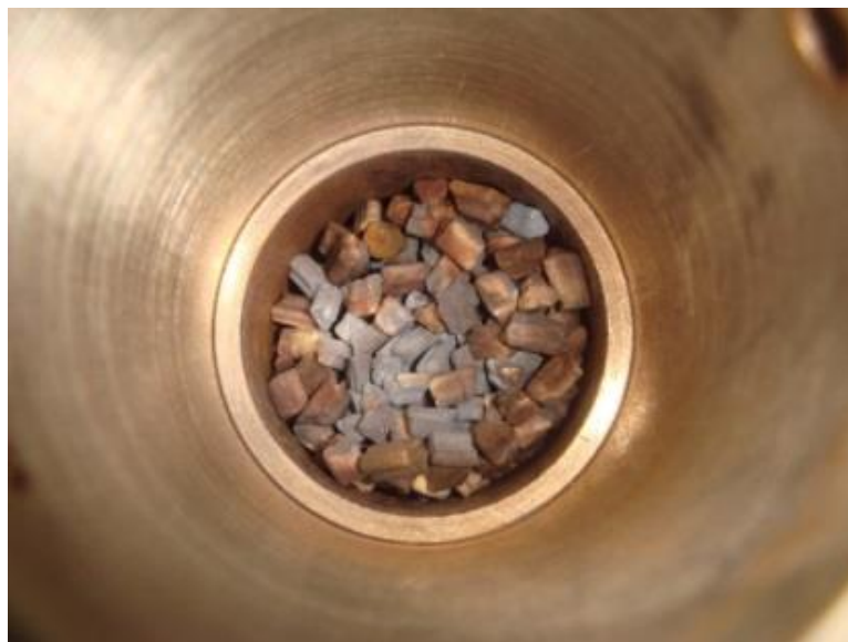
Figura 4.13 - Retração da alumina criando espaços vazios no leito.
