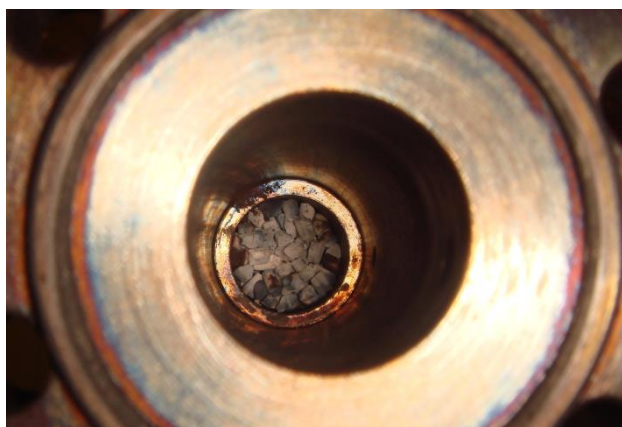
Figura 4.25 - Acomodação do catalisador no leito de 30 mm
