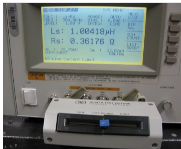
Figura 3.16 - Medição da indutância do indutor comercial pela frequência.
