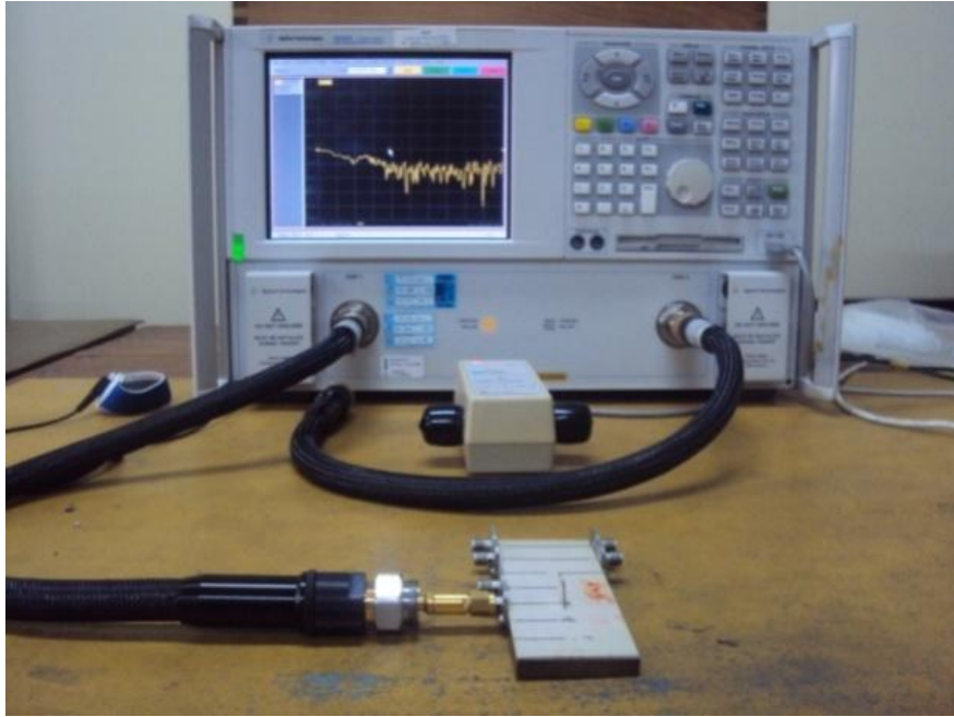
Figura 3.9 - Set-up utilizado na caracterização do dielétrico [2].
