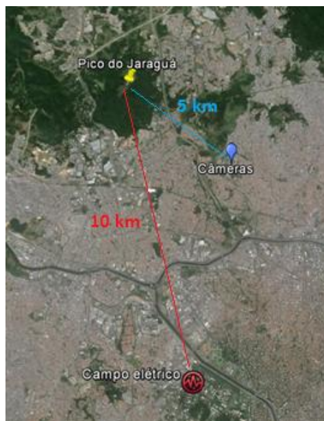
Figura 3.3 - Local da Instrumentação em São Paulo. O indicador amarelo indica o local do Pico do Jaraguá, o vermelho indica o local do sensor de campo elétrico e em azul, as câmeras de alta resolução voltadas para o Pico.
