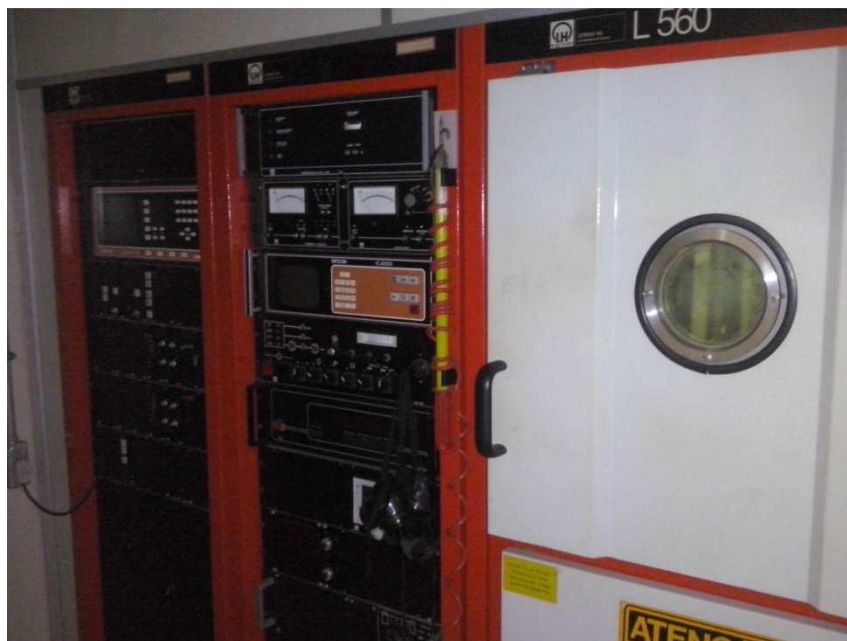
Figura 3.1: Câmara a vácuo utilizada para deposição por EB-PVD alocada no IEAv.
