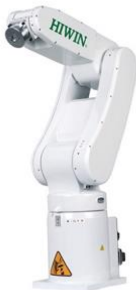
Figura 3.1 - Robô articulado ou revoluto.
