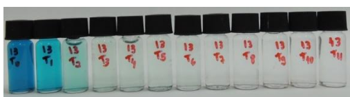
Figura 5.2-Imagens das soluções do corante Verde brilhante eletrolisadas em meio de K_2SO_4 ( 0,1 \text{ mol L}^{-1} ), utilizando densidades de corrente de (A) 30, (B) 75 e (C) 100 \text{ mA cm}^{-2} para o eletrodo de dopagem de 15000 ppm, em função do tempo de eletrólise.
