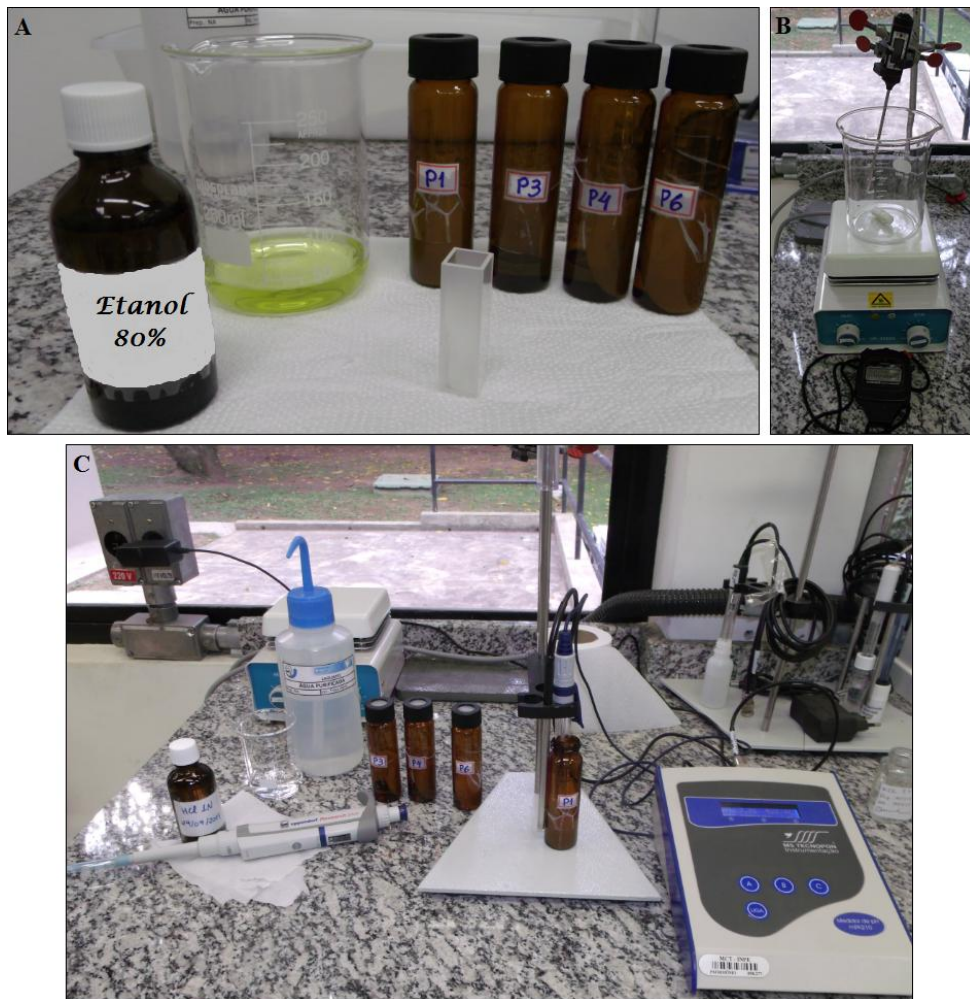
Figura 4.14 - (A) Extração da clorofila com etanol 80% e cubeta usada na leitura, (B) equipamento utilizado para o banho maria e (C) acidificação da amostra de clorofila extraída.
