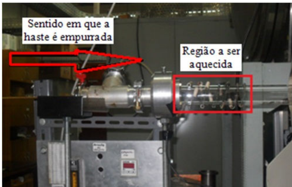
Figura 3.2: Foto do sistema de evaporação do ferroceno e da cânfora
