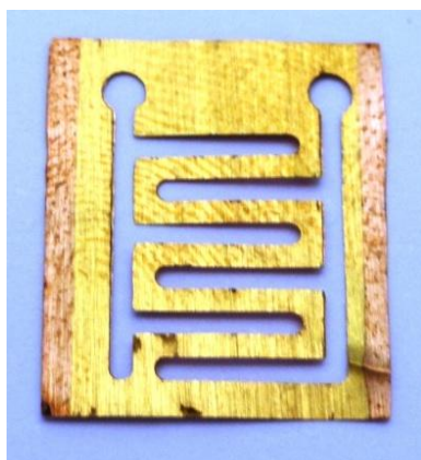
Figura 3.14: Máscara utilizada para depósito do eletrodo de Au.
