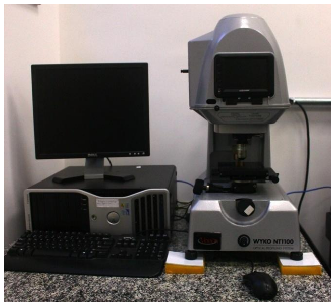
Figura 3.9: Perfilômetro Óptico do LAS/INPE.
