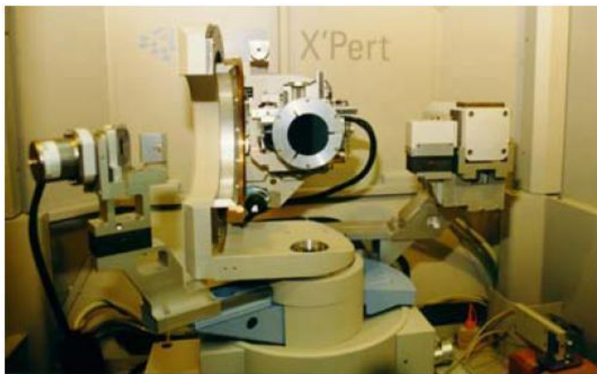
Figura 3.10: Difratorômetro de raios X de alta resolução Philips X'Pert MRD do LAS/INPE.
