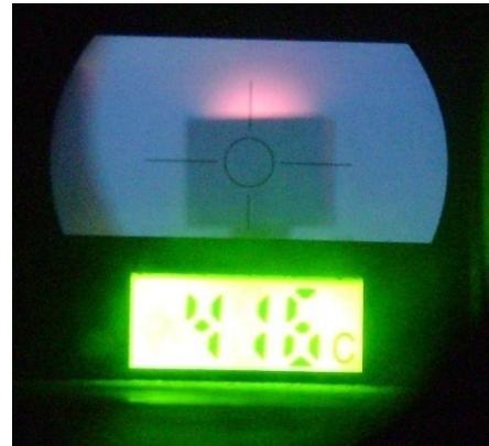
Figura 3.4: a) Cadinho durante o processo de vaporização do Zn; b) Cadinho durante o processo de vaporização com indicação da temperatura pelo pirômetro.
