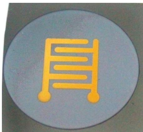
Figura 3.15: Filme de ZnO sobre Si com o eletrodo de Au.
