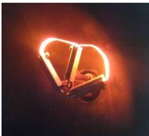
Figura 3.2: Foto do catodo óxido durante processo de ativação.
