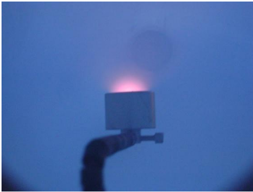
Figura 3.4: a) Cadinho durante o processo de vaporização do Zn; b) Cadinho durante o processo de vaporização com indicação da temperatura pelo pirômetro.
