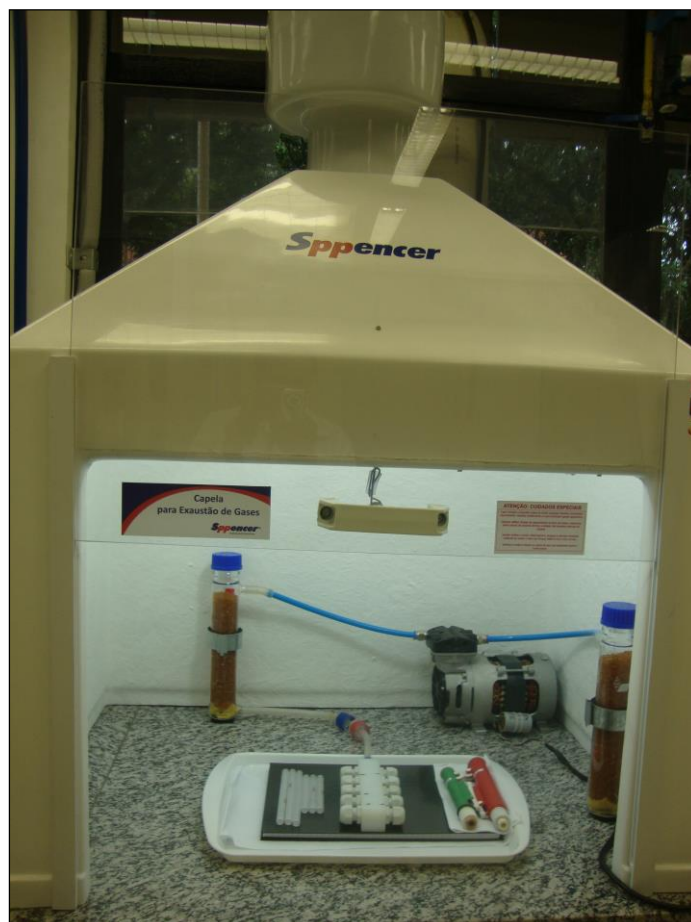
Figura 7: Sistema de secagem montado na capela. Fotografia: Crispim S.P. (2013)
