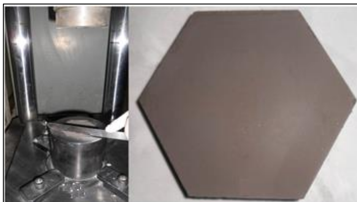
Figura 3.2 - Compactação e amostra de cerâmica compactada.
