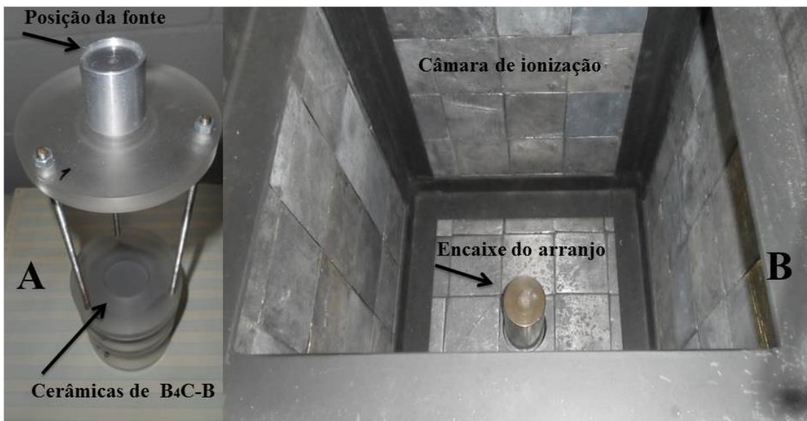
Figura 3.4 - Arranjo experimental para a transmissão de raios gama com cerâmicas de B 4 C-B (A). Local de encaixe do arranjo no detector de germânio hiper puro dentro da câmara de ionização (B).
