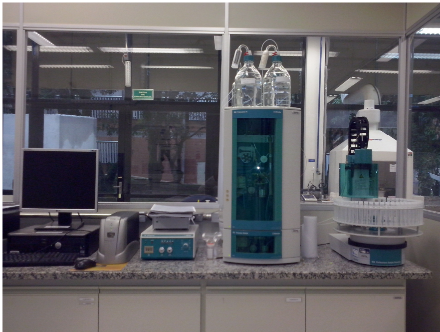
Figura 2: Foto do Cromatógrafo a Líquido de Íons instalado no LAQUATEC.
