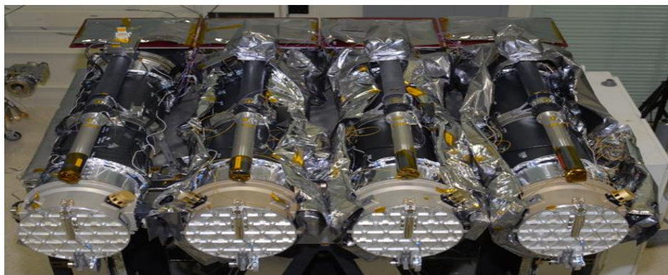
Figura 4.2.3.2: Instrumento AIA, instalado no satélite SDO. Fonte: http://sdo.gsfc.nasa.gov/assets/img/site/AIA.jpg
