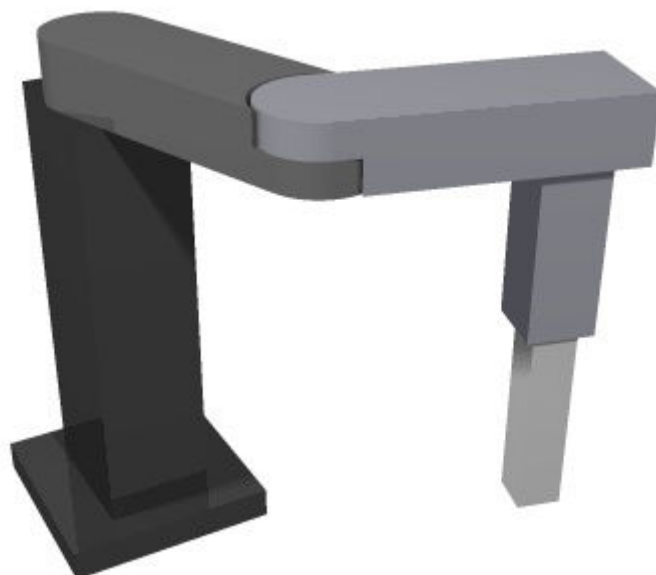
Fig. 2.16 – Robô com articulação horizontal SCARA.
