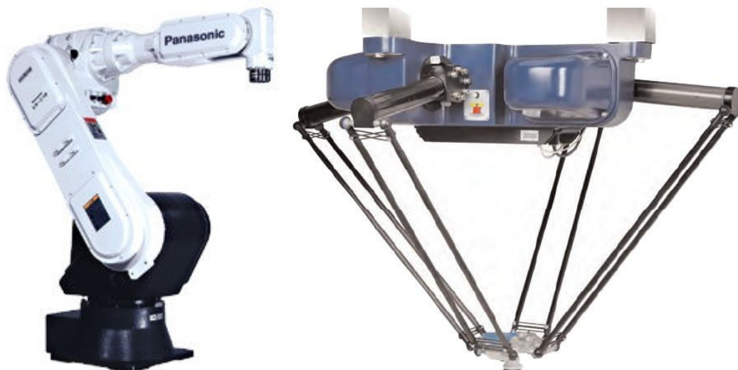
Fig. 2.20 – Um braço revoluto de cadeia aberta comercializado pela Panasonic (à esquerda), e o robô paralelo Quattro produzido pela Adept (à direita).
