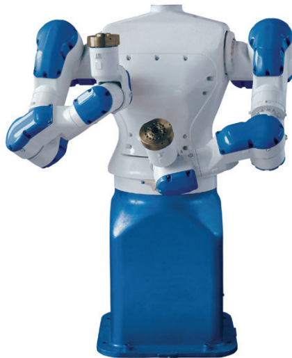
Fig. 2.11 – Manipulador em cadeia aberta com dois braços unidos por uma única base.
