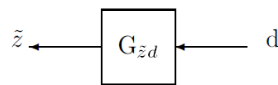
Figura E.2 - Função de transferência, entrada perturbações e saída erro estimado. Fonte: Adaptado de Rawicz (2000)
