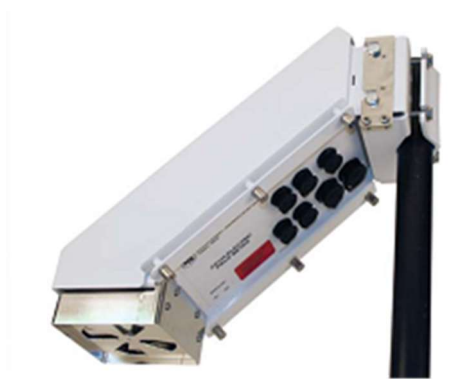
Figura 4.7 – Sensor Campbell CS110 com datalogger CR1000 acoplado.
