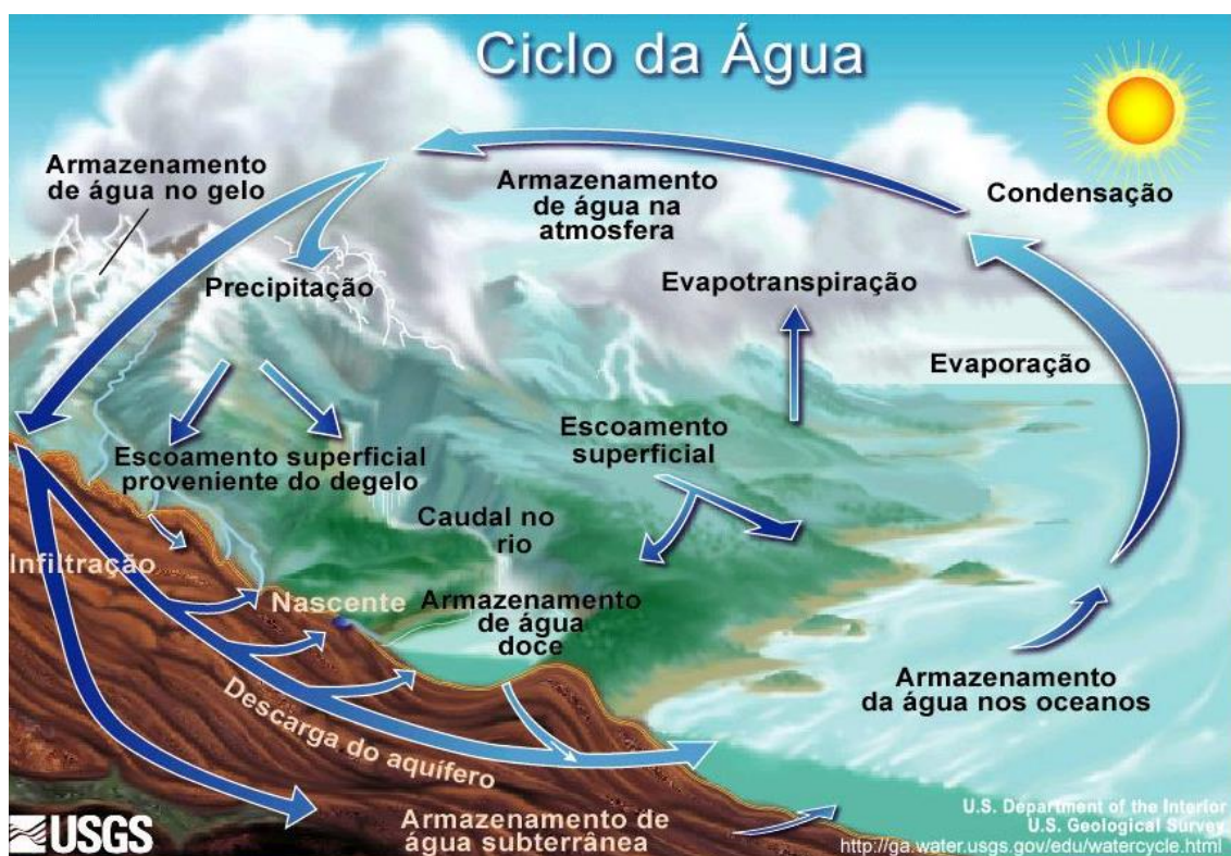
Figura 1.3– Figura esquemática mostrando os principais reservatórios de água participantes do ciclo hidrológico e os principais processos de troca de massa entre eles.
