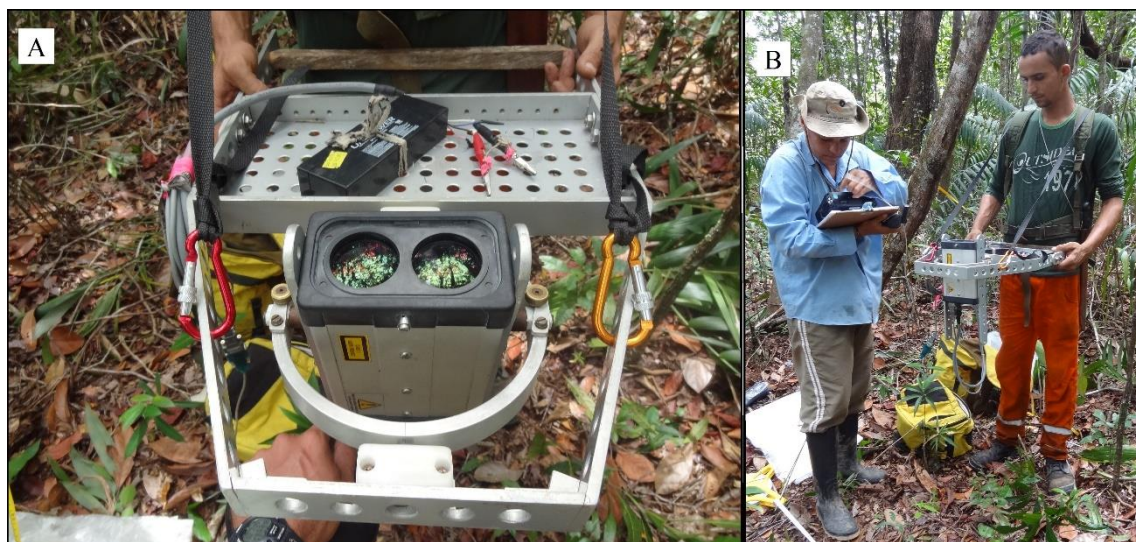
Figura 2.6. (A) Sistema LiDAR terrestre portátil contendo estrutura de alumínio de apoio à bateria de 12v e estrutura frontal, com um sistema balanceador de movimento para apoio. (B) Operadores do sistema, no qual um maneja o computador de mão (à esquerda), gravando os arquivos a cada 10 m, e outro opera o LiDAR, caminhando ao longo do transecto.
