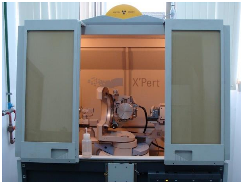
Figura 3.3: Difratorômetro de Raios-X localizado no LAS INPE
