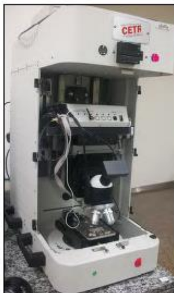
Figura 3.11: Tribômetro UMT localizado no LAS do INPE
