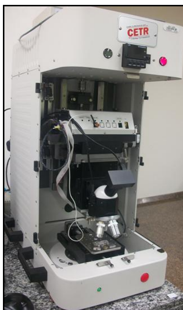
Figura 3.2 - Tribômetro utilizado para teste de esclerometria.
