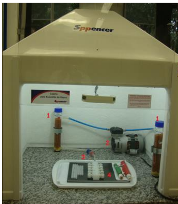
Figura 7: Sistema de secagem de denuderes montado na capela. (1. Compartimentos com sílica gel laranja; 2. Bomba; 3. Filtros de linhas de caráter ácido e alcalino e 4. Manifold para conectar os denuderes).
