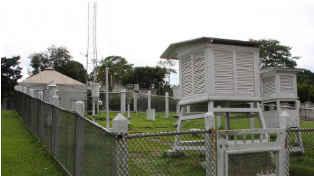
Figura 4.2 - Estação convencional de superfície.
