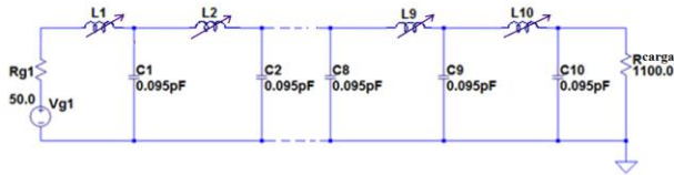
Fig. 10. Esquema básico do circuito do LT-Spice para o modelo do Dolan. O fluxo magnético através dos indutores é dado por (4) com L_0 = 465 nH, L_S = 4,65 nH, e I_S = 3,76 A.
