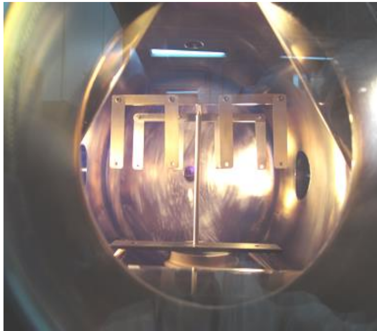
Figura 5.3. Amostras planas de alumínio 2024 tratadas por 3IP de nitrogênio em nova configuração. Aqui elas foram presas e suspensas, onde o tratamento visava alcançar uma melhoria na resistência à corrosão para aplicação no sistema espacial e aeronáutico.
