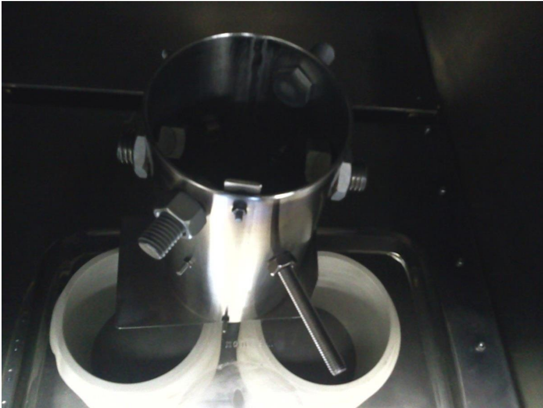
Figura 6.17. Parafusos em aço inox fazem a simulação das peças reais da trava de segurança da câmera MUX.
