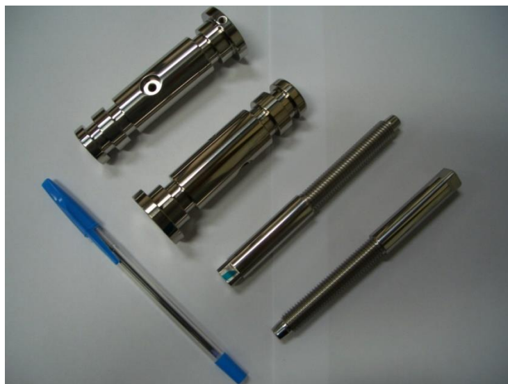
Figura 6.16. Peças reais do sistema de travamento da objetiva da câmera MUX do satélite CBERS.
