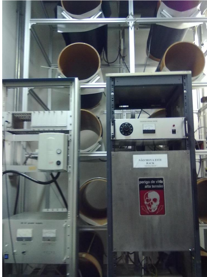
Figura 5.14. Sistema carregador de tensão do tipo Blumlein. As bobinas são carregadas em paralelo e descarregadas em série, com tensão nominal máxima de 120 kV.
