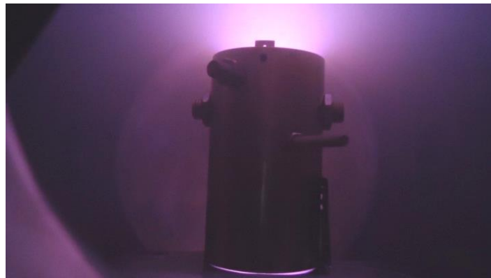
Figura 6.18. Vista lateral do suporte tubular com amostras durante o tratamento 3IP.
