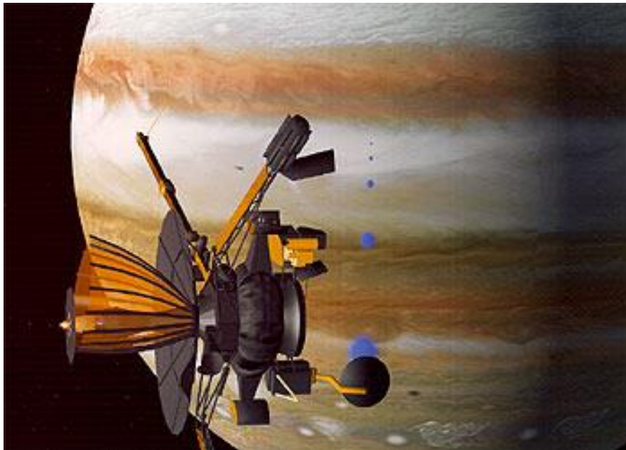
Figura 1.3. Antena apresentada de forma artística (ilustrada), orbitando a lua de Júpiter. Devido a falha, a antena de alto ganho permaneceu parcialmente fechada comprometendo seu empenho e obrigando que a comunicação fosse feita apenas pela antena de baixo ganho.
