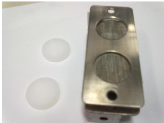
Figura 5.16. Amostras de PEAD com 20mm de diâmetro e 3 mm de espessura. O suporte e a grade são de aço inox. Os pulsos são aplicados no suporte e grade.
