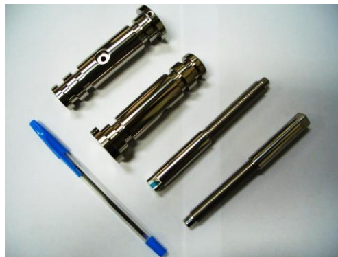
Figura 1.6. Pinos da trava de segurança da objetiva da câmera MUX.
