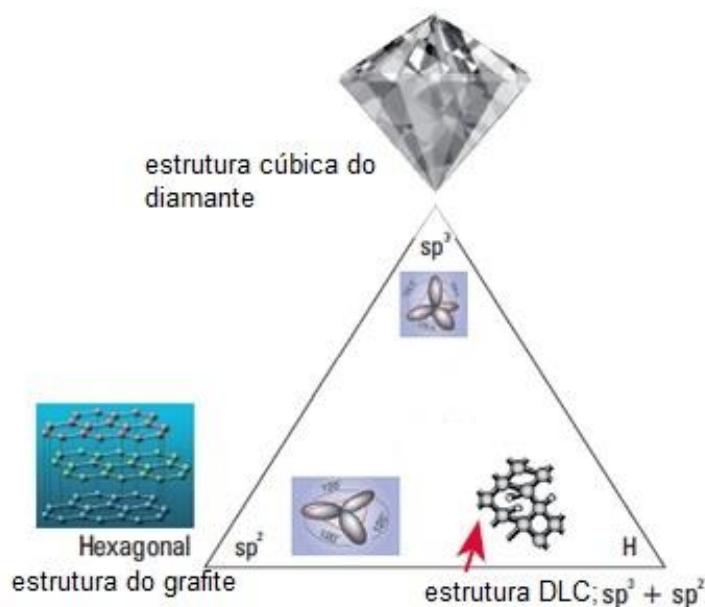
Figura 5.15. Pirâmide de representação das ligações de carbono-carbono e carbono-hidrogênio.
