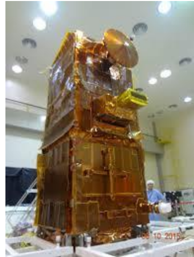
Fig. 2 - The actual Amazonia-1 Thermal Model
