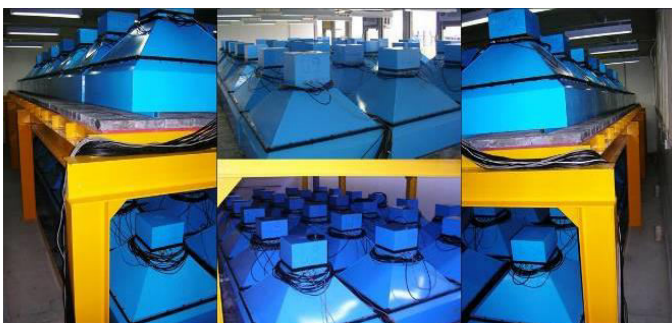
Figura 3: Detector Multidirecional de Múons de São Martinho da Serra – RS. Fonte: Arquivos Pessoais.
