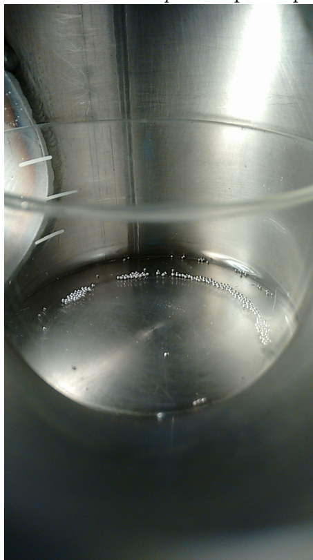
Figura 4.13 - Amostras no coletor do drop tube após a queda em microgravidade.
