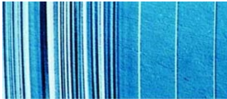
Figura 2.5 - Cristal semiconductor de germânio dopado com gálio
