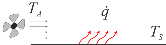
Figura 2.12 - Refrigeração de superfície por meio de um ventilador
