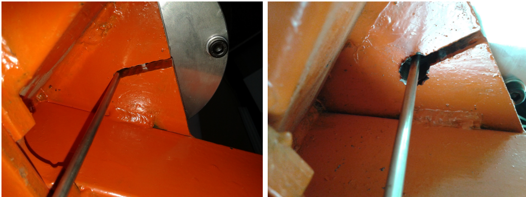
Figura 8.9 - Detalhe do furo por onde passa a haste que suspende o MNP.
