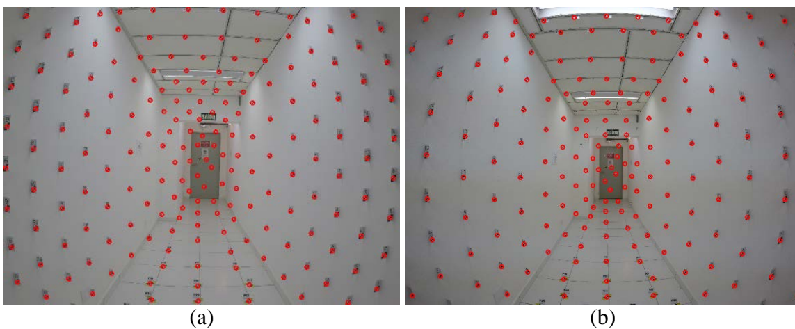
Figura 3.20 – Imagens obtidas no campo de calibração pela câmera GoPRO, com indicação dos marcos capturados: (a) modo FOV Medium e (b) modo FOV Wide .
