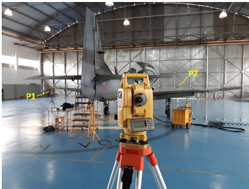
Figura 3.31 – Levantamento da poligonal topográfica com Estação Total Topcon GPT-3105W estacionada no ponto P3 e prismas posicionados nos pontos P1 e P2.
