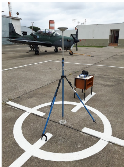
Figura 3.6 – Receptor GNSS Novatel DL-V3 posicionado com tripé no pátio do IPEV sobre um ponto geodésico, usado como base para correção diferencial do receptor embarcado na aeronave.
