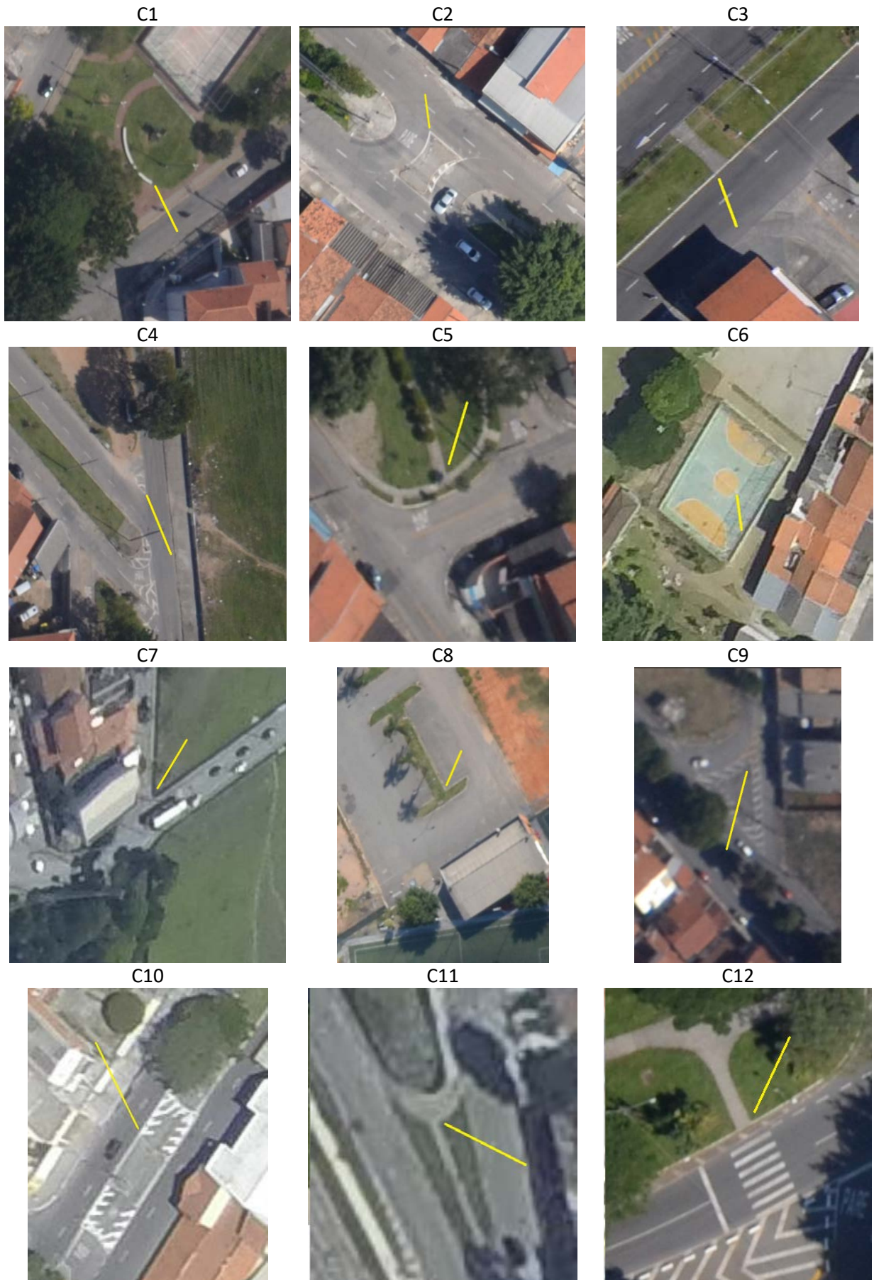
Figura I.2 - Detalhe das feições no terreno escolhidas para levantamento das coordenadas.
