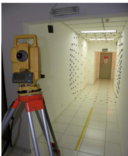
Figura 3.15 – Estação Total topográfica Topcon GPT-3105W, usada para levantamento das coordenadas dos marcos de referência do campo de calibração do IEAv.
