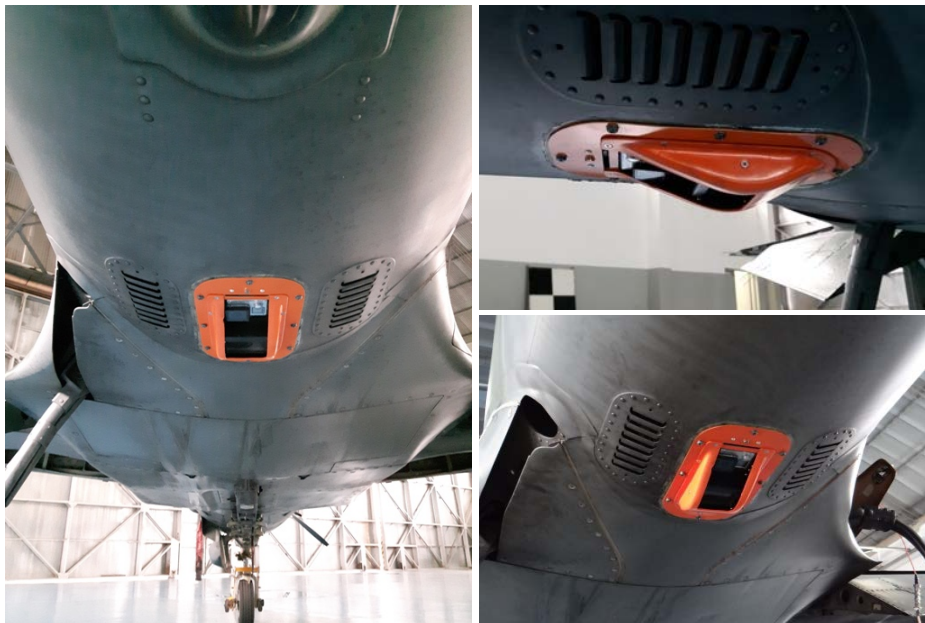
Figura 3.12 – Detalhes do suporte de fixação das câmeras, montado na aeronave e pronto para o voo.
