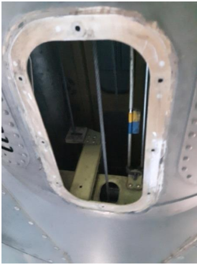
Figura B.5 – Instalação do suporte com as câmeras na aeronave.
