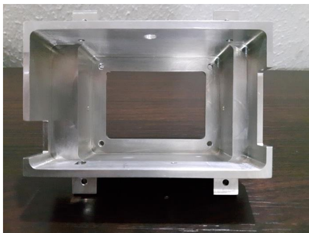
Figura B.3 – Caixa da câmera Nikon usinada em alumínio.
