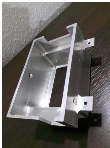
Figura B.3 – Caixa da câmera Nikon usinada em alumínio.
