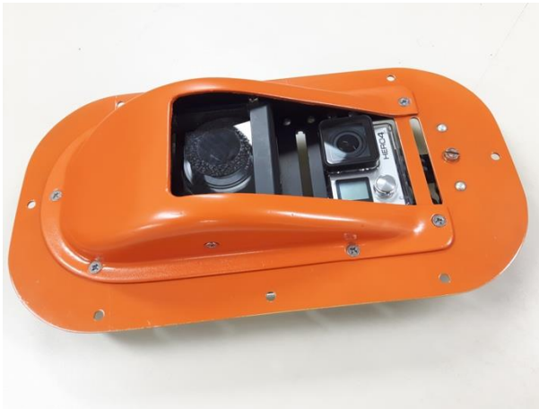
Figura B.4 – Suporte de fixação montado com as câmeras.
