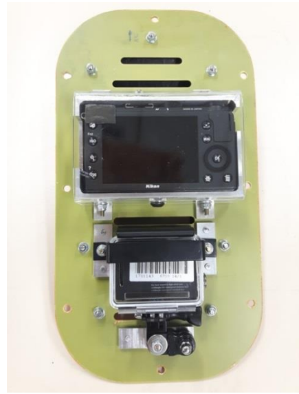
Figura B.4 – Suporte de fixação montado com as câmeras.
