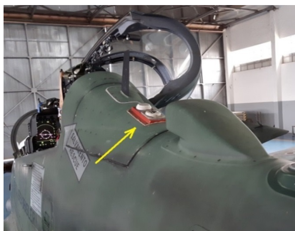
Figura 3.5 – Localização da antena do receptor GNSS DL-V3 Novatel na aeronave.
