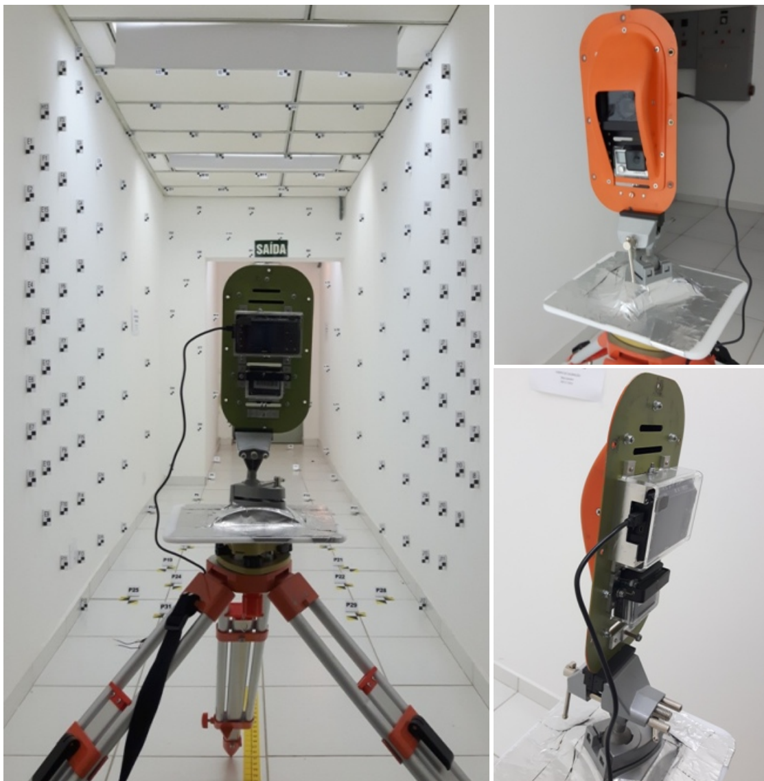
Figura 3.18 – Posicionamento das câmeras Nikon e GoPRO com visor de acrílico no campo de calibração do IEAv para adquirir as imagens usadas no processo de identificação dos parâmetros de distorção geométrica.
