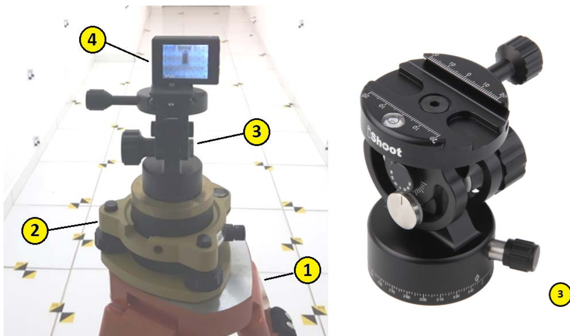
Figura 3.17 – Dispositivos previstos para fazer a orientação externa da câmera no campo de calibração do IEAv.
