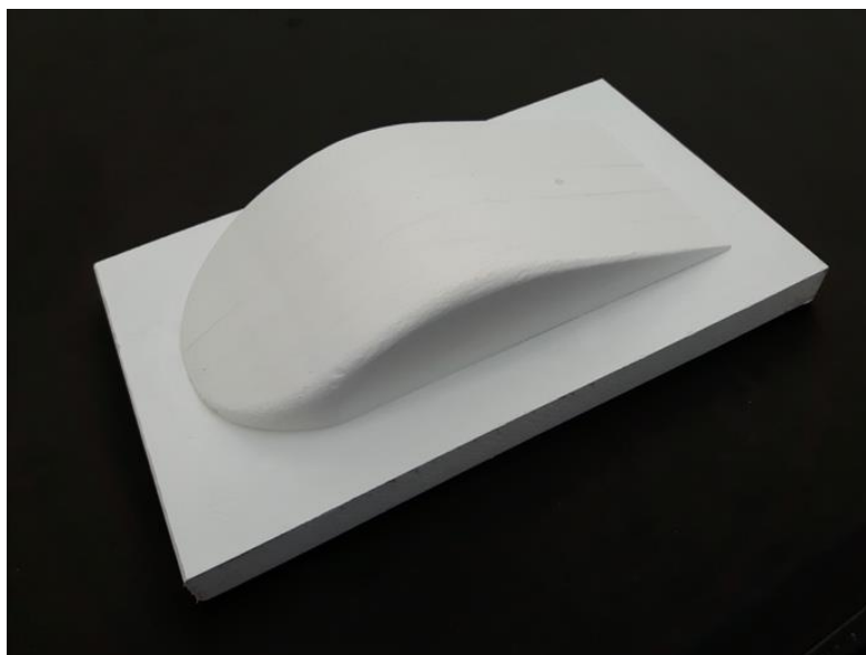
Figura B.2 – Molde em madeira e peça bruta da carenagem em fibra de vidro.
