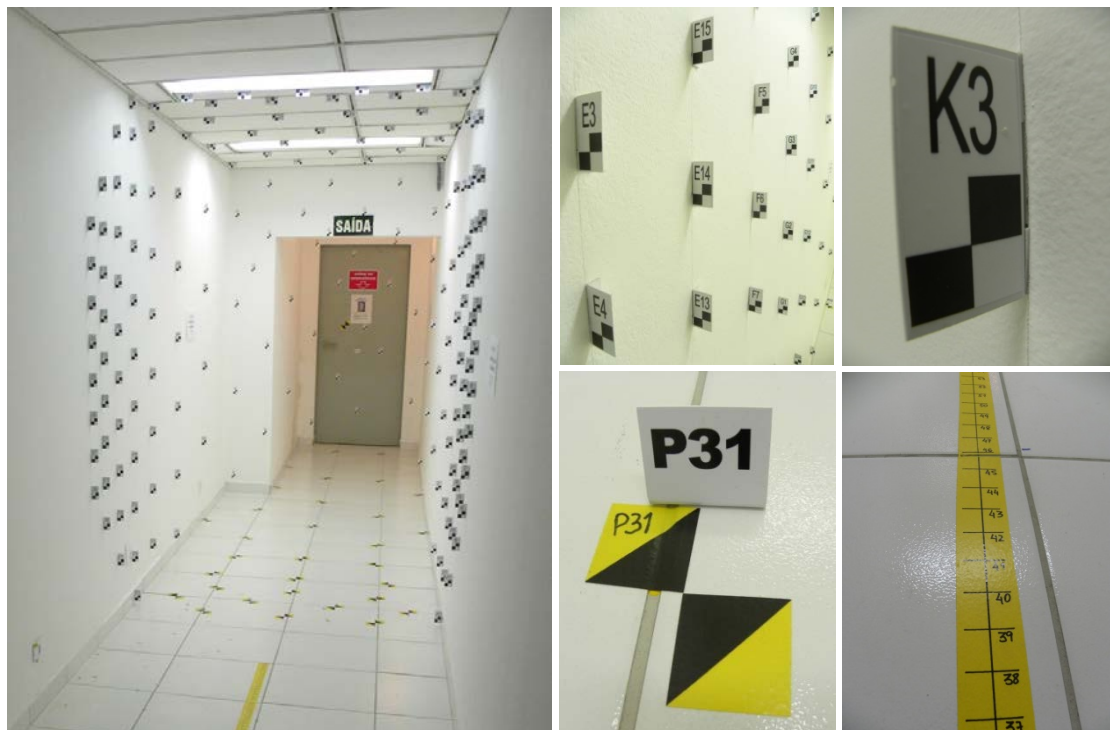
Figura 3.13 – Campo de calibração geométrica construído no IEAv. Detalhe para os marcos codificados fixados nas paredes, no teto, e para a régua no piso com posições identificadas para estacionar a câmara.
