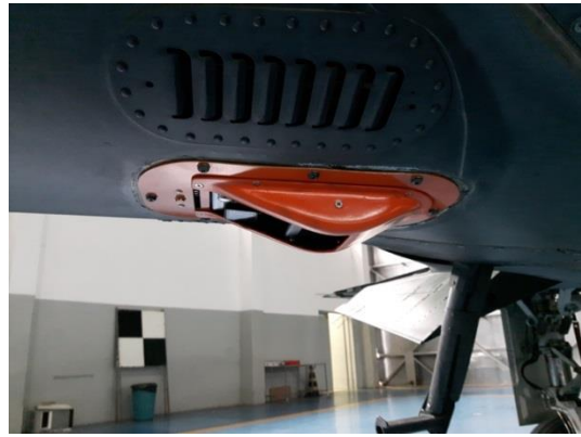
Figura B.5 – Instalação do suporte com as câmeras na aeronave.
