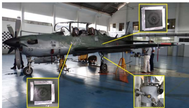
Figura 3.29 – Marcas de referência na aeronave para nivelamento longitudinal e lateral.
