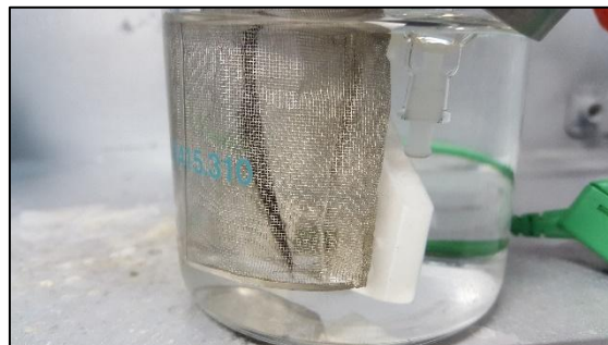
Fig. 3. Célula eletroquímica utilizada na síntese de polianilina sob fibra de carbono.
