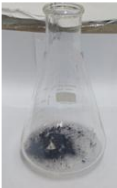
Figura 3. 3 - Mistura de grafite em pó e \text{NaNO}_3 .
