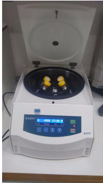
Figura 3. 6 - Processo de centrifugação da solução.
