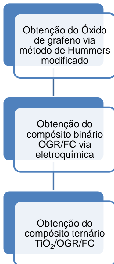
Figura 3. 1 - Fluxograma experimental da obtenção dos compósitos.
