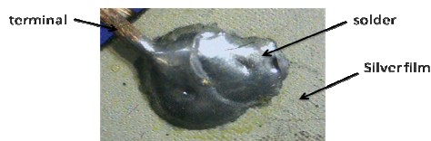
Figura 7. Terminal de cobre firmemente soldado ao eletrodo metálico PZT sem rachaduras ou delaminação do filme.
