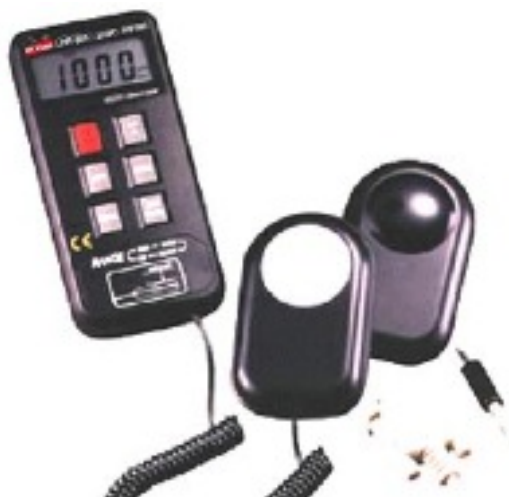
Figura 2. Luxímetro LDR-380 utilizado nas medidas de campo realizadas para validação do algoritmo e avaliação da influência da nebulosidade e relevo na relação entre iluminância natural e ângulo zenital solar.
