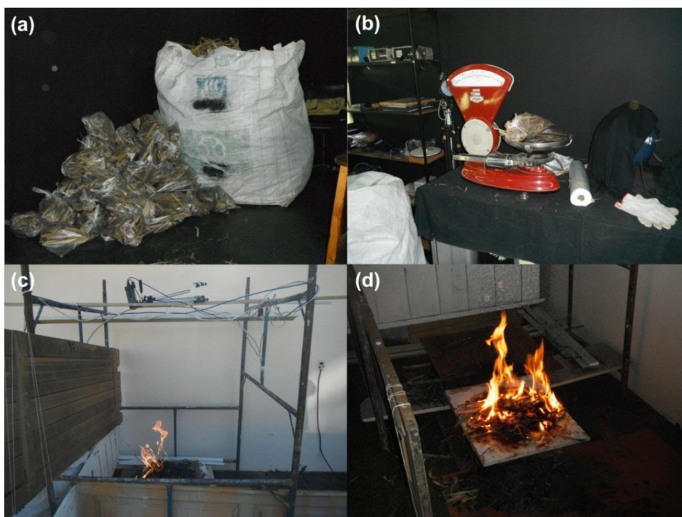
Figura 4.1 - Etapas realizadas para a execução do experimento de combustão. A palha da cana-de-açúcar (4.1 (a)) foi separada e pesada (4.1(b)) de acordo com a Tabela 4.1. A Figura 4.1(c) mostra a câmera termal posicionada com ângulo de visada de 20° durante a queima de uma amostra e a Figura 4.1(d) apresenta uma amostra de palha de cana-de-açúcar de 200g durante o processo de combustão.
