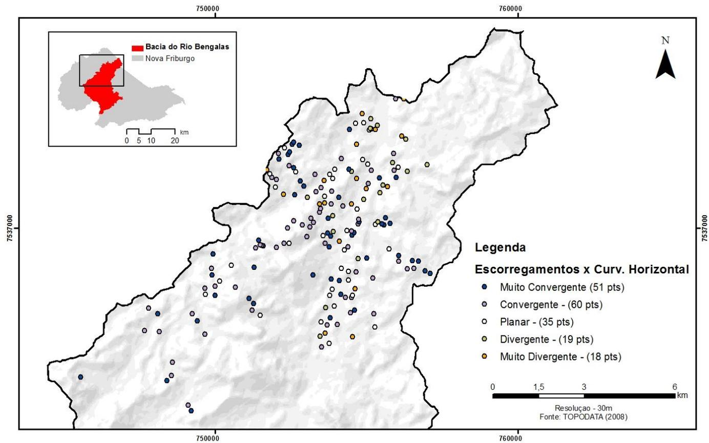
Figura 57. A Curvatura Horizontal e os Pontos de Escorregamentos de Terra
