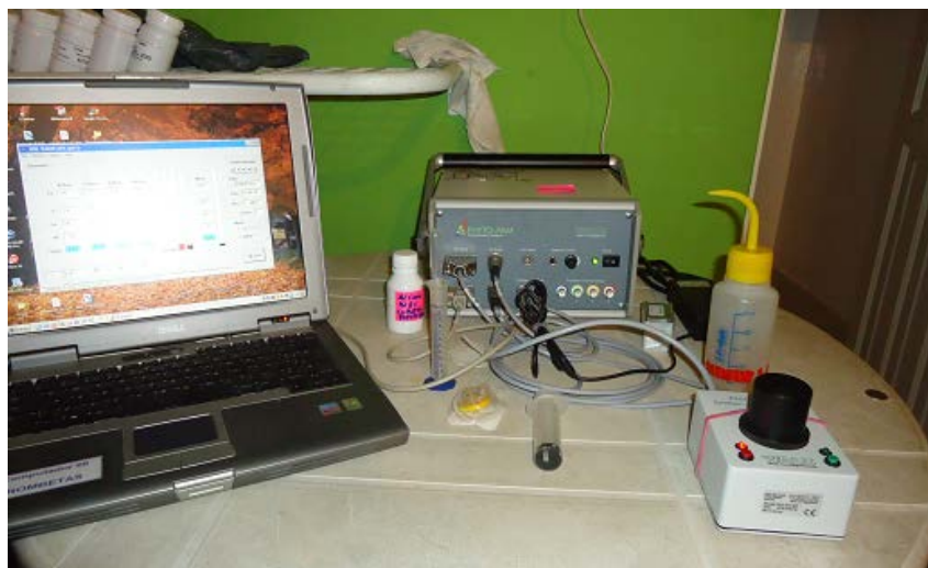
Figura 4.2: Phyto-Pam utilizado para a determinação da concentração de clorofila dos pontos amostrados no reservatório da UHE Funil.
