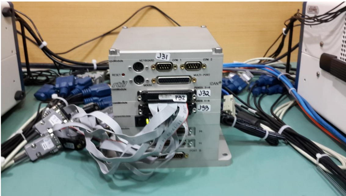
Figura 5.5. Computador de Bordo com arquitetura x86
