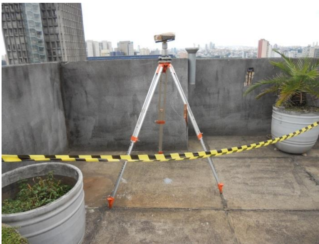
Figura 4.3 – Ponto-base, posicionado no topo do edifício do SEMASA.
