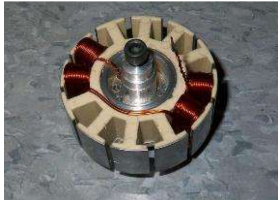
Figura 2.4 - Estator de um motor DC sem escovas
