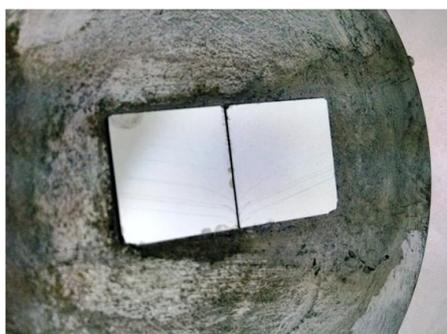
Figura 5.2 – foto das amostras imediatamente após a deposição. Além das amostras, a imagem também expõe uma parte da superfície do porta substrato, de molibdênio, na qual pode-se ver diferentes tonalidades de cinza, originada pela solução de índio-gálio espalhada, de modo não uniforme, pelo tempo de uso.
