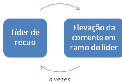
Figura 3.13 – Fluxograma da interatividade cíclica observada entre líderes de recuo e a elevação da corrente em outro ramo do líder positivo de relâmpagos nuvem-solo positivos.
