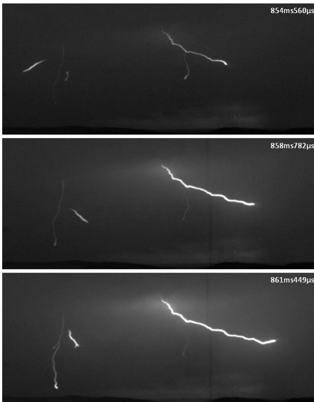
Figura 3.2 – Sequência descontinuada de quadros mostrando dois ramos principais supostamente de um único líder positivo do relâmpago nuvem-solo observados pela câmera rápida a 9.000 qps (exposição de 110 \mu s) em South Dakota, EUA, em 17/jun/2010, 01:37:03 UTC. Fonte: vídeo 4387 de Weathervideohd (2014).
