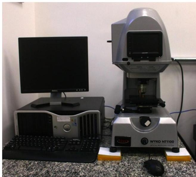
Figura 3.9: Perfilômetro Óptico do LAS/INPE.
