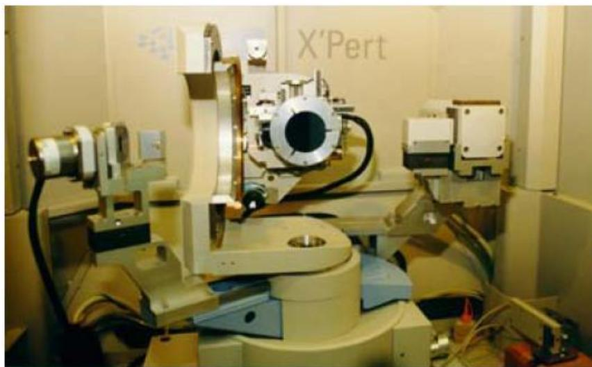
Figura 3.10: Difratorômetro de raios X de alta resolução Philips X'Pert MRD do LAS/INPE.
