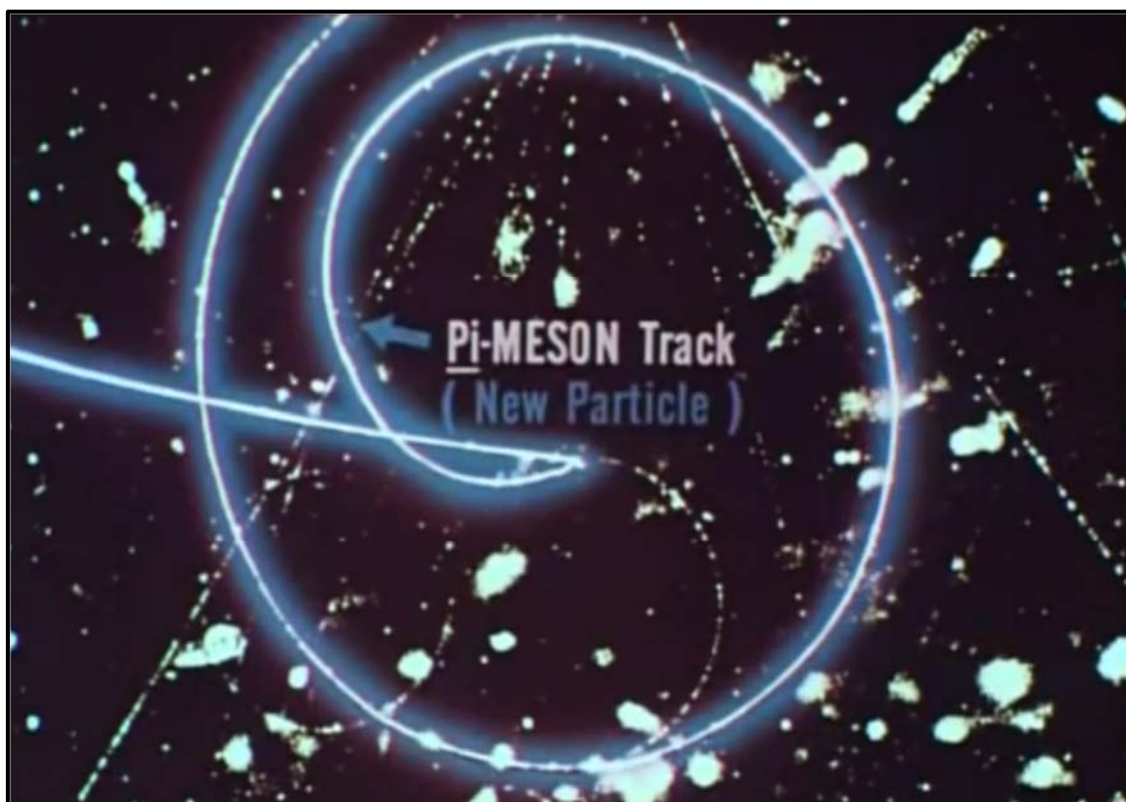
Figura 1.8 – Visualização da trajetória de um píons através do registro fotográfico de uma Câmara de Wilson (também conhecida como Câmara de Nuvens).
